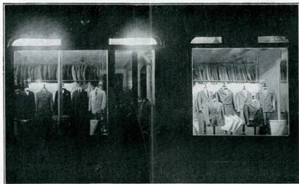
Fig. 2. — Grandes vitrines, à gauche, ancienne installation avec un écartement de 50 lux; à droite, installation pendant l'essai avec 800 lux.
